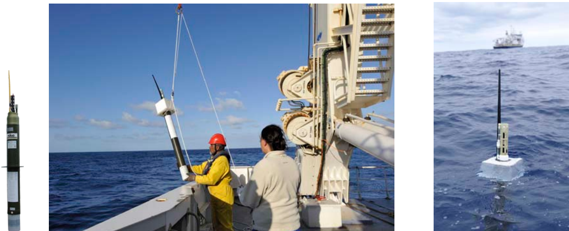
Figure 1 : Mise à l'eau d'un flotteur Argo depuis le navire Le Pourquoi-Pas ? © Ifremer.
